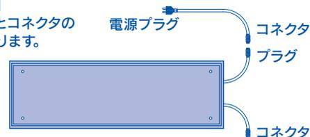
※電源右送りを逆さまに配置するとリード線が交差します。(その分配線距離も短くなります)
