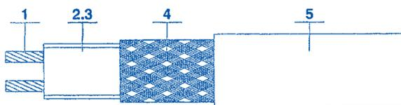
1. ニッケルメッキ銅より線(母線導体16AWG:給電ライン/1.25mm<sup>2</sup>相当)
